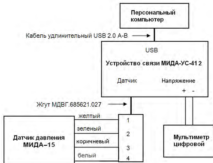
Рисунок Р.1- Блок-схема подключения датчика с выходным сигналом 0,5-4,5 В
